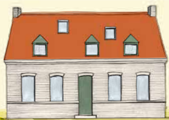
absence de composition des ouvertures de toiture
